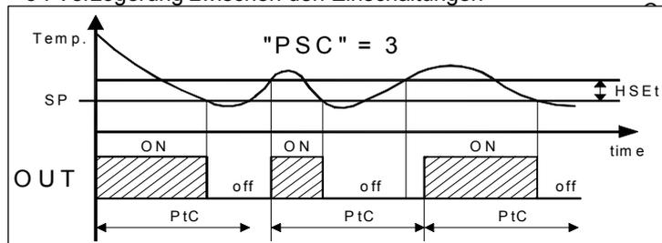
Steht der Parameter "PtC" = 0, ist diese Funktion deaktiviert. Während der Einschaltverzögerungen des Ausgangs OUT durch Hemmung der Funktion "Compressor Protection" blinkt die Led OUT.
