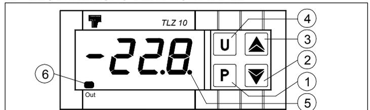
**1 - Taste P** : Wird zur Eingabe des Sollwertes und zur Programmierung der Betriebsparameter verwendet.
